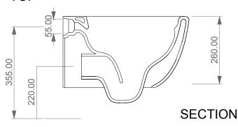
Designation Vaso sospeso Like XXS senza brida con sistema di scarico Smart Clean Like XXS wc wall-hung rimless with Smart Clean flushing system Scale 1:10 cod. LKWCSOXXS
